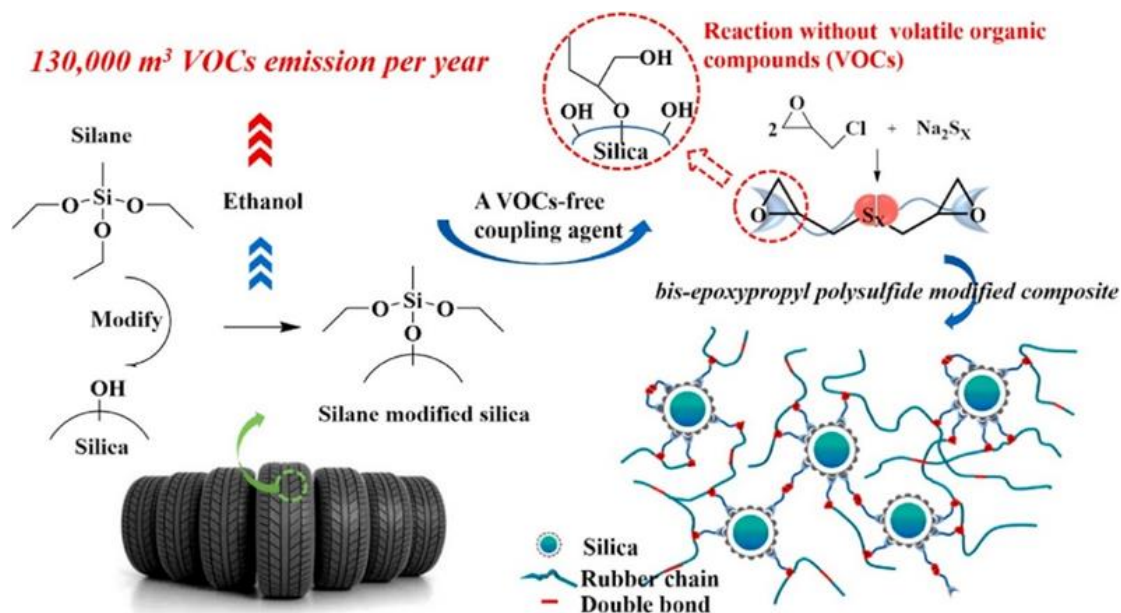
图 1-13 BEP 在硅填充橡胶中的耦合机理 [72]
