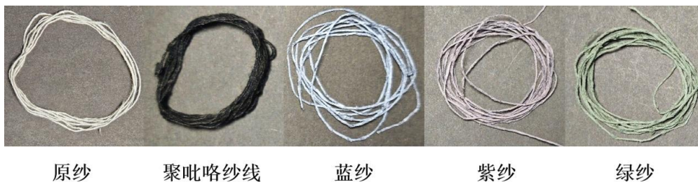
图 3-5 结构色棉纱制备过程颜色变化照片
