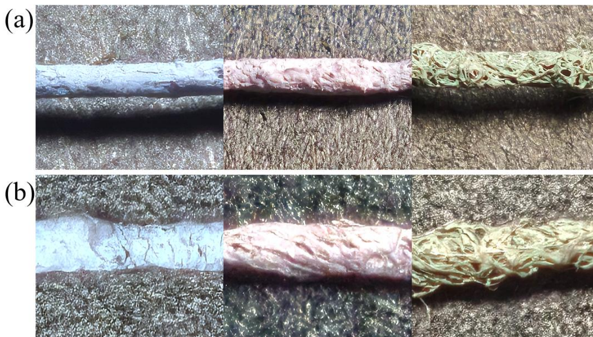
图 3-9 结构色棉纱耐温对比照片 (a) 原样; (b) 经过 210 °C 处理的样品
