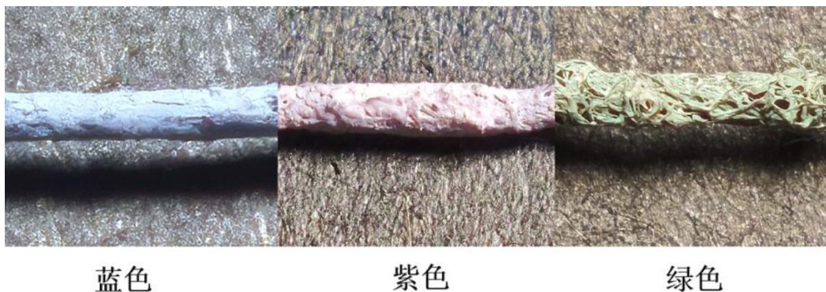
图 3-7 结构色棉纱放大照片 (30x)
