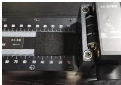
图 5-13 织物弯曲强度测试
