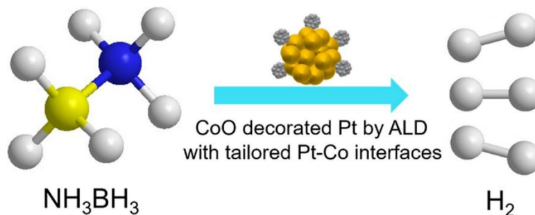
图 1-10 \text{PtCo}_{20}/\text{CNTs} 催化氨硼烷水解制氢示意图 [76]
