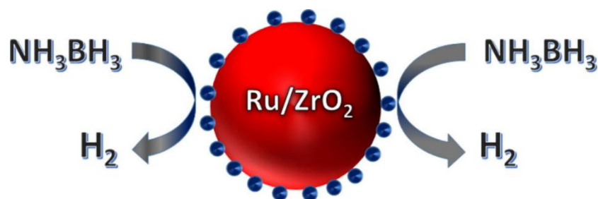
图 1-12 \text{Ru}^0/\text{ZrO}_2 催化氨硼烷水解制氢示意图 [78]
