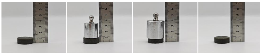
图 3-5 DF-TiO 2 /DFC 水凝胶分别受 100 g 和 200 g 砝码压力前后的光学图片
