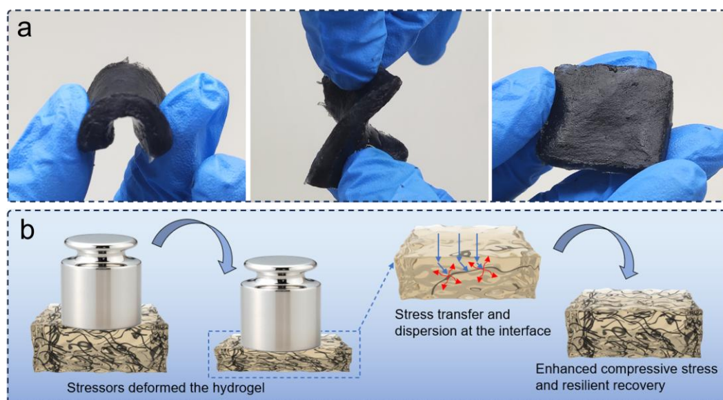
图 2-6 CS-PVA@DFC 水凝胶折叠和扭曲后的光学图片及其力学性能改善示意图
