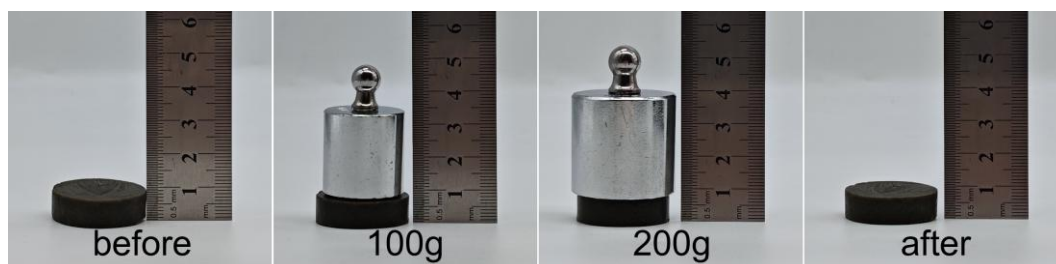
图 4-5 DF-TiO 2 /CuO@DFC 水凝胶分别受 100 g 和 200 g 砝码压力前后的光学图片
