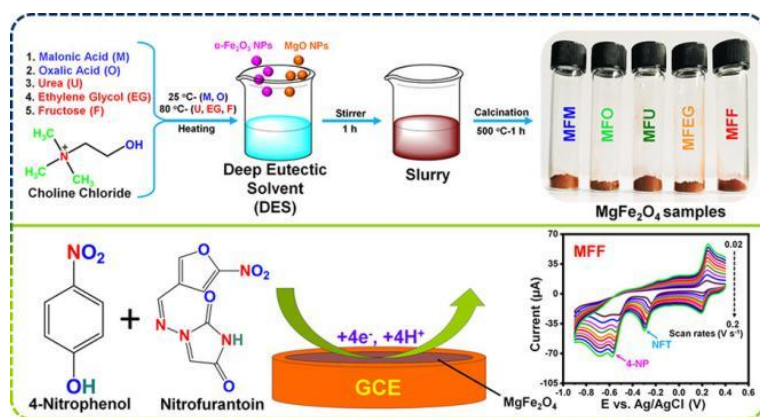
图 1-6 各种 DESs 辅助 \text{MgFe}_2\text{O}_4 的合成路线及其在 NFT 和 4-NP 电化学检测中的应用示意图 [31]
