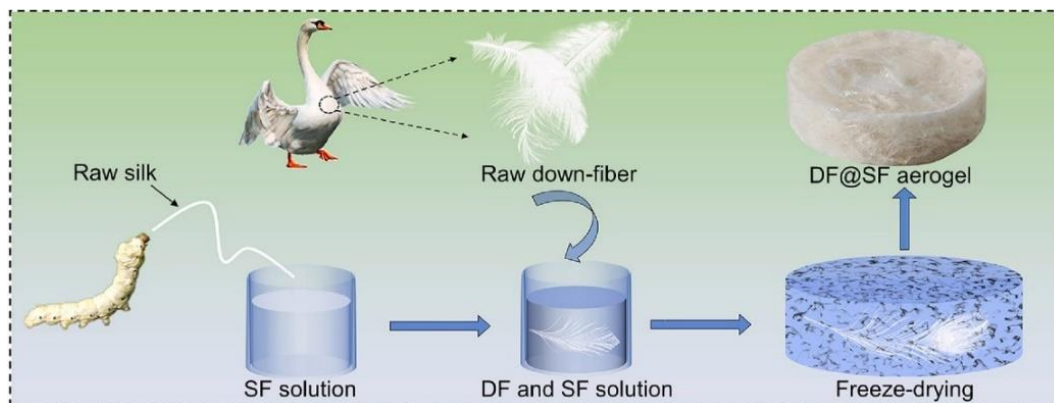
图 2-1 DF@SF 气凝胶的制备过程示意图.
