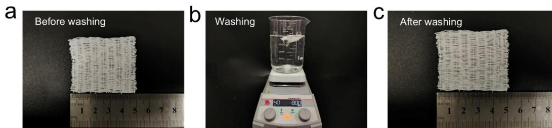
图 4-13 CA-SF 织物的洗涤模拟: a) 洗涤前; b) 以 800 rpm 的速度洗涤 40 min; c) 洗涤后.
