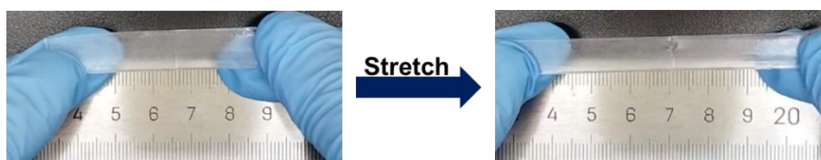
图 2-13 自愈合 poly(AA-co-NaAMPS)拉伸时的照片。
