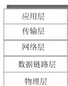
图5.2 TCP/IP网络模型
