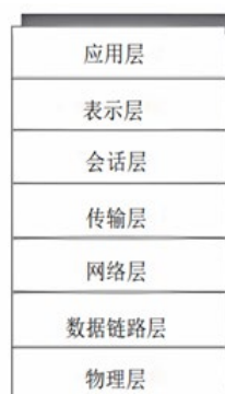
图5.1 OSI分层网络模型
