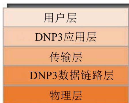
图6.2 DNP3网络协议栈
