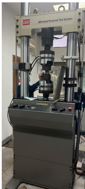
图 2-14 MTS809 万能试验机
