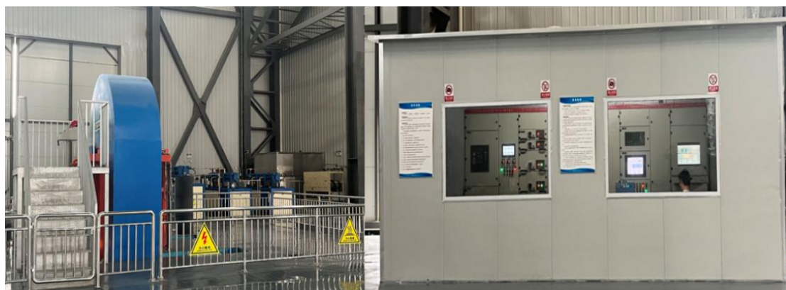
图 2-4 热等静压设备及控制室
