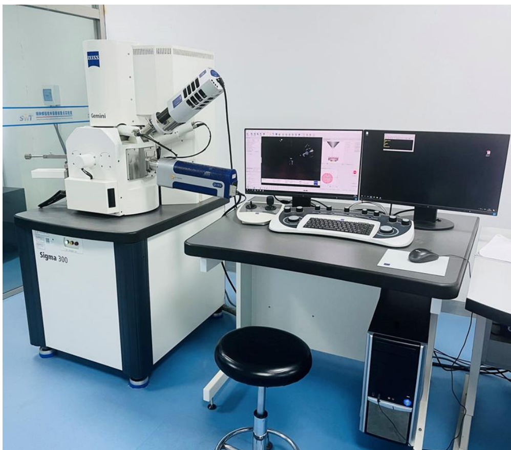
图 2-11 Sigma300 型蔡司高分辨场发射扫描电子显微镜
