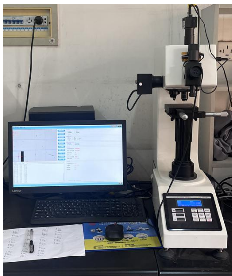
图 2-12 BUEHLER VH-3100 型显微维氏硬度计
