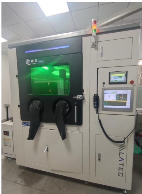
图 2-4 定向能量沉积(DED)设备
