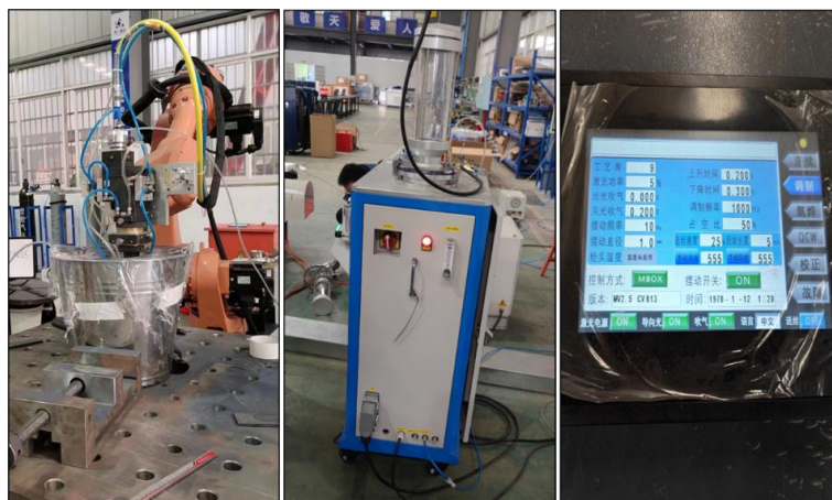
图 2-5 激光熔覆设备：(a) 机械臂；(b) 送粉器；(c) 激光控制器面板
