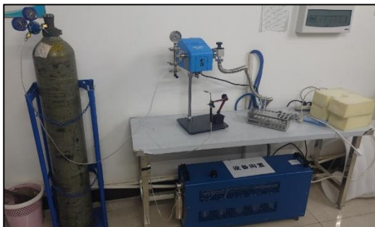
图 2-7 氩气气氛封管设备
