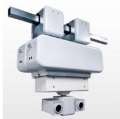
（b）轨道式巡检机器人
