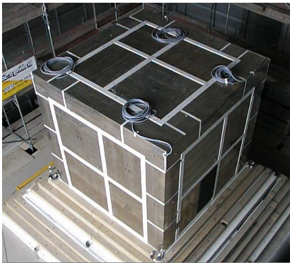
图 1-1 德国 PTB 的零磁装置
