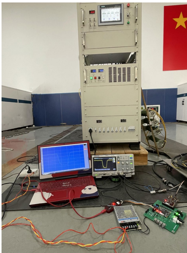
图 6-9 高压调制器输出信号对比实验
