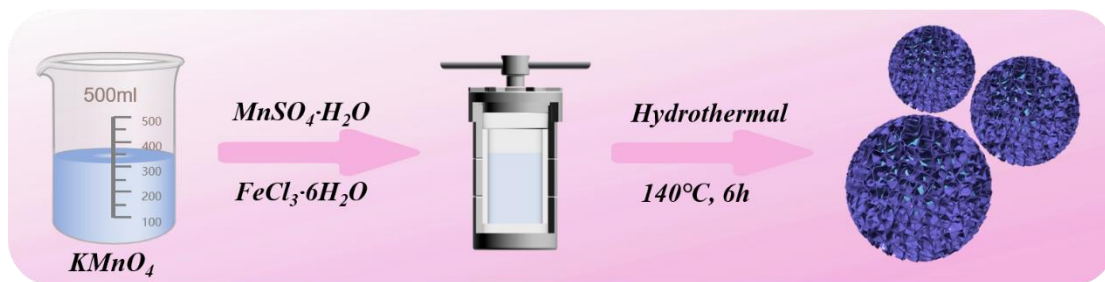
图 2-1 \text{MnO}_2 和 MnFe-x 的制备流程图。
