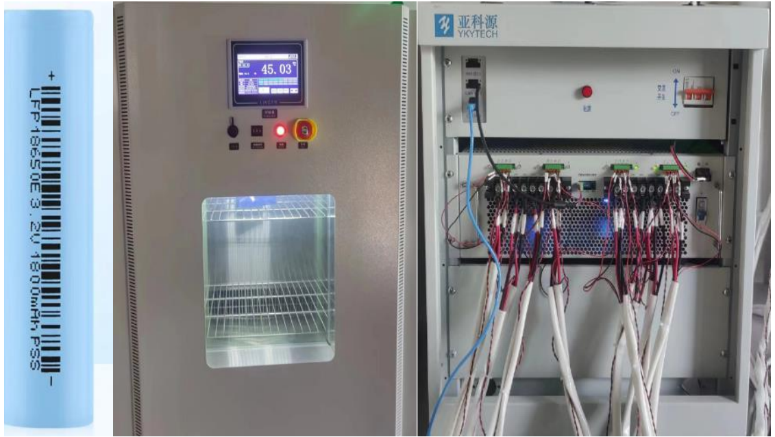
图 2.2 电池容量检测平台
