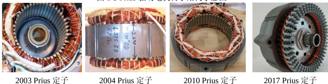
图 1-6 Prius 驱动电机定子结构示意图 [13]
