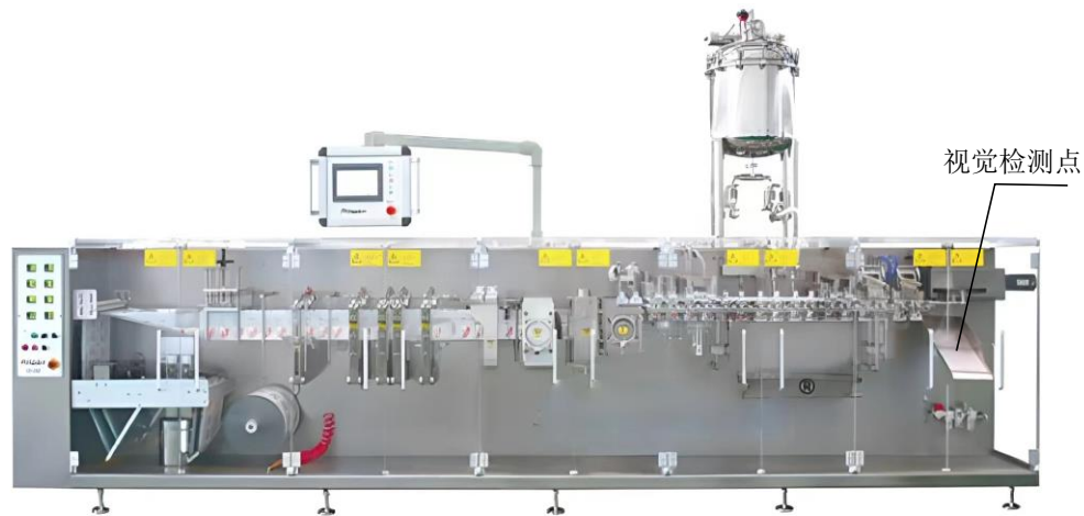
图 4-1 DS180-DS 自立袋包装机示意图
