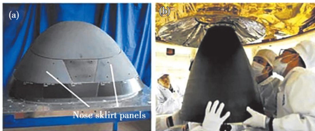
图 1-1 C_f/SiC 复合材料的应用：(a) X-38 头锥帽 [17] ；(b) 远征 3 号 5000 N 发动机喷管 [18, 19]
