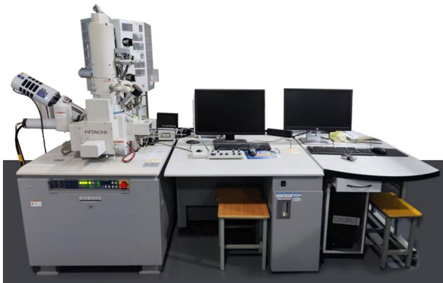
图 2-5 扫描电子显微镜仪器图
