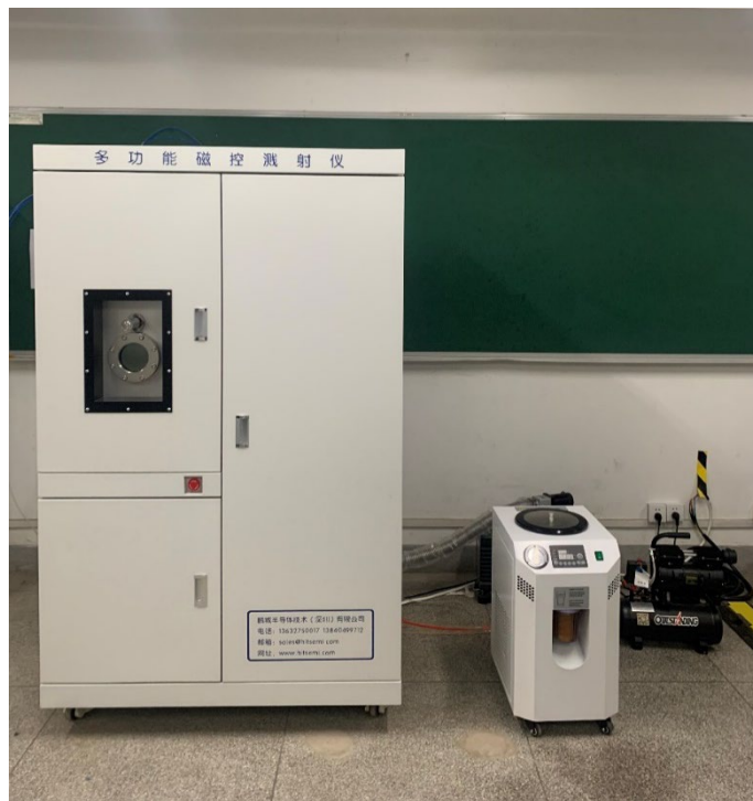
图 2-4 多功能磁控溅射仪
