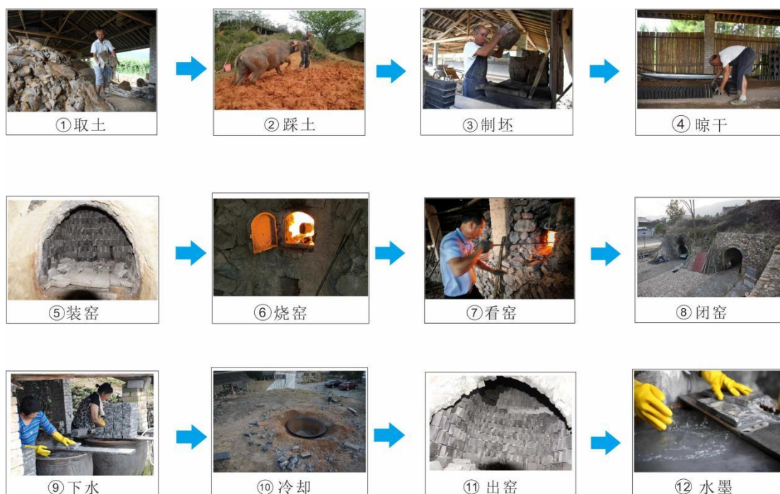
图 3-17 水墨花砖制作流程图（图片来源：作者自制）
