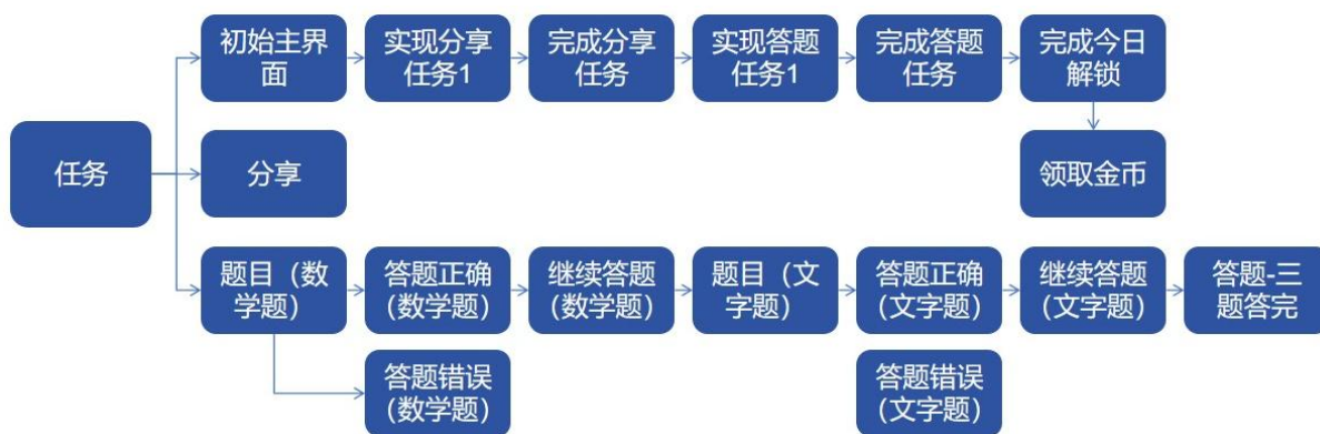
图 6-23 “任务”模块使用流程图
