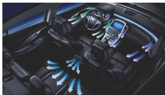
图 3-16 汽车新风系统内循环
