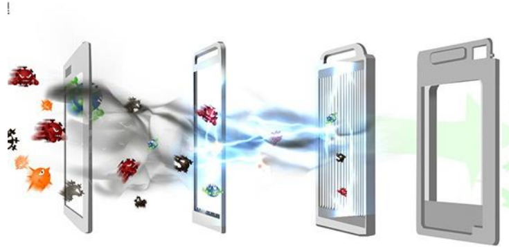
图 3-11 静电集尘技术过滤示意图
