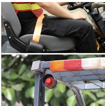
图 2-5 叉车安全带提醒装置 安全带报警器
